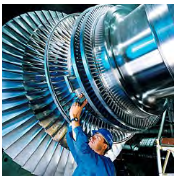
蒸気タービン
